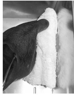
4 اغسل جميع مكونات المرشح. اغسل جميع مكونات المرشح بمحلول مركز ممتاز لكافة الأغراض (A.P.S.C) من McD® وقم بالشطف. لا تقم باستخدام منظف أو ماء داخل وعاء المرشح. امسح الزيت المتبقي والرواسب من داخل وعاء المرشح بقطعة قماش جافة ونظيفة أو مناشف ورقية.
