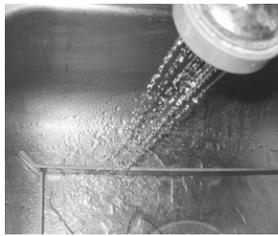
6 اشطف مكونات المرشح وقم بإعادة تجميعها. اشطف جميع الأجزاء بماء نظيف (باستثناء وعاء المرشح من الداخل) وجفف جميع أجزاء المرشح كليًا. قم بإعادة تجميع أجزاء المرشح بهذا الترتيب: شاشة الدعم وورقة التصفية وحلقة الشد.
